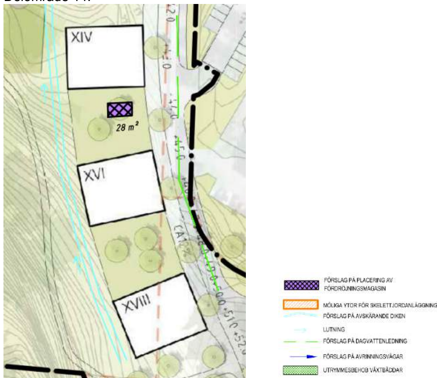
Figur 37: Exempel på placering av kassetter. För krav på dagvattenkassetter se Bilaga 1 och för föreslagen utformning se Bilaga 7.
