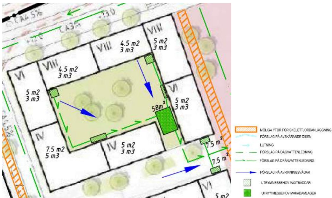
Figur 22: Exempel på placering av växtbäddar, makadamlager, dräneringsledning och avrinningsvägar. Fastigheternas fördröjningskrav och växtbäddarnas utrymmesbehov redovisas på varje fastighet (För krav på mängd växtbäddar och makadam se Bilaga 1 och för föreslagen utformning se Bilaga 6)
