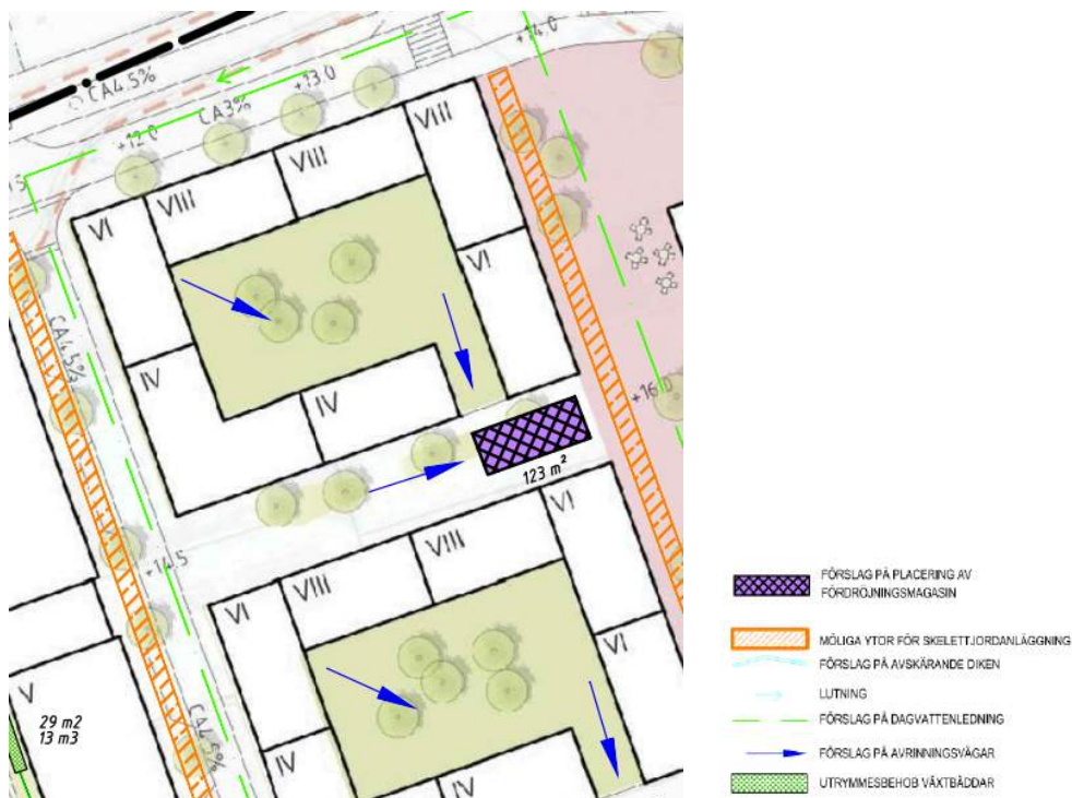
Figur 30: Exempel på placering av kassetter. För krav på dagvattenkassetter se Bilaga 1 och för föreslagen utformning se Bilaga 7.
