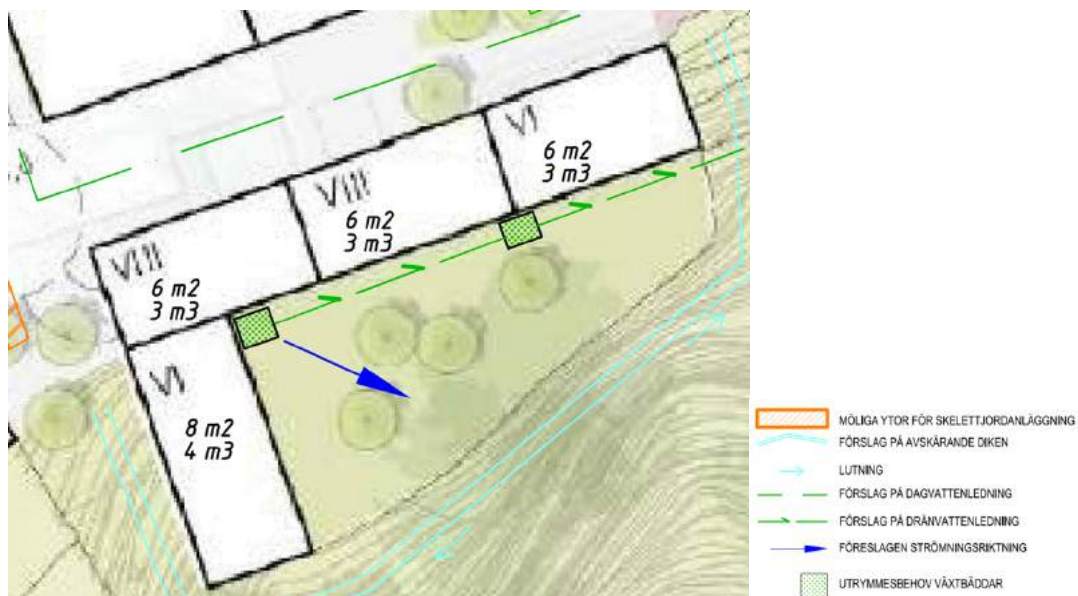
Figur 11: Exempel på placering av växtbäddar, dräneringsledningar och avrinningsvägar på delområde 5. Fastigheternas fördröjningskrav och växtbäddarnas utrymmesbehov redovisas på varje fastighet (för krav på mängd växtbäddar se Bilaga 1 och för föreslagen utformning se Bilaga 5)
