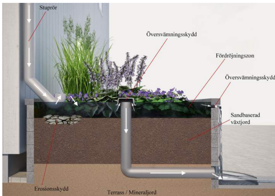
Figur 8: Exempel på utformning av växtbädd med översvämningsskydd (Källa: Movium faktablad)
