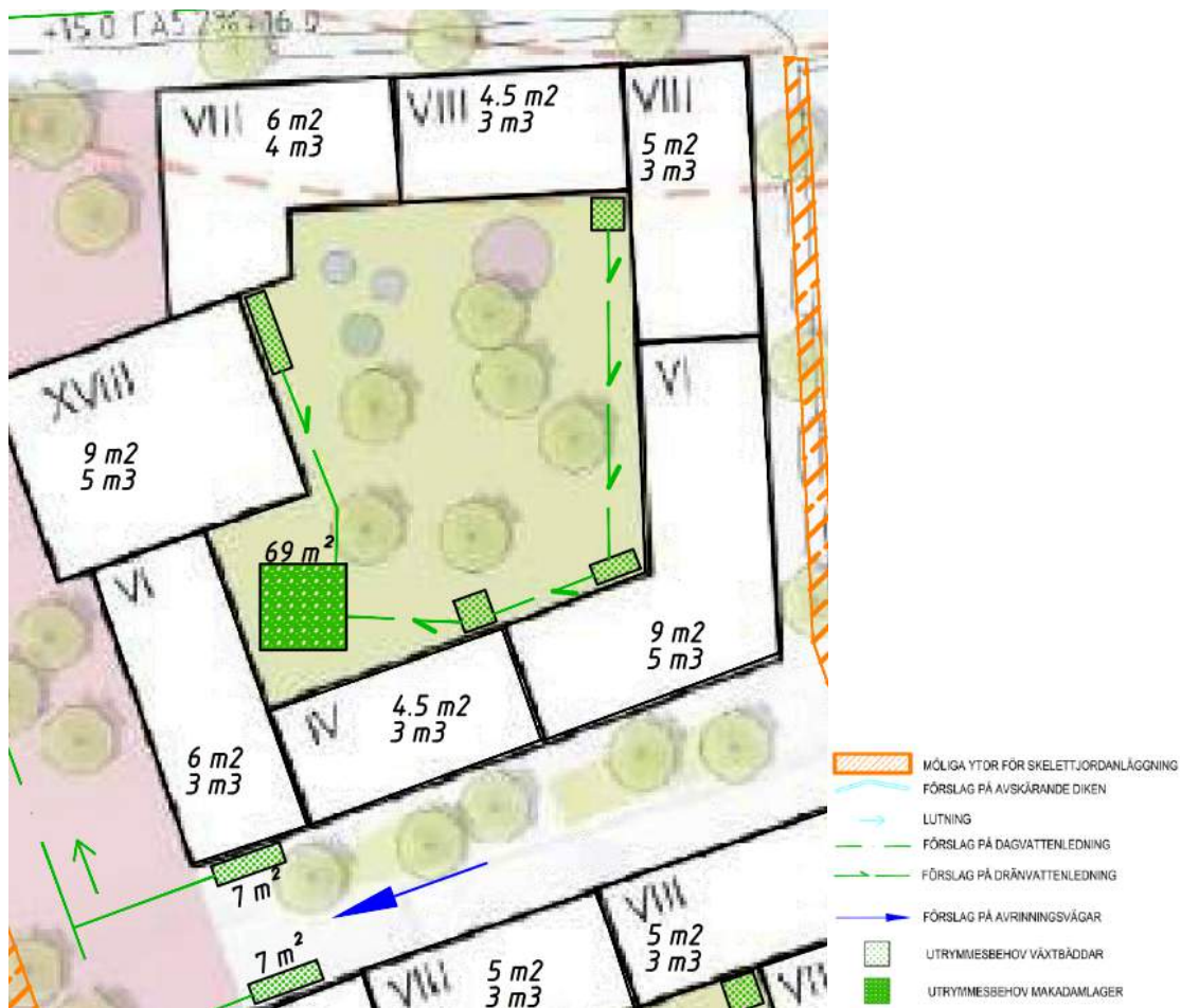
Figur 24: Exempel på placering av växtbäddar, makadamlager, dräneringsledning och avrinningsvägar. Fastigheternas fördröjningskrav och växtbäddarnas utrymmesbehov redovisas på varje fastighet (För krav på mängd växtbäddar och makadam se Bilaga 1 och för föreslagen utformning se Bilaga 6)
