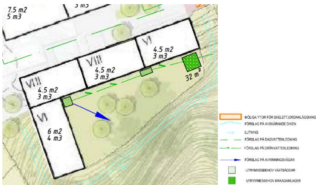
Figur 23: Exempel på placering av växtbäddar, makadamlager, dräneringsledning och avrinningsvägar. Fastigheternas fördröjningskrav och växtbäddarnas utrymmesbehov redovisas på varje fastighet (För krav på mängd växtbäddar och makadam se Bilaga 1 och för föreslagen utformning se Bilaga 6)
