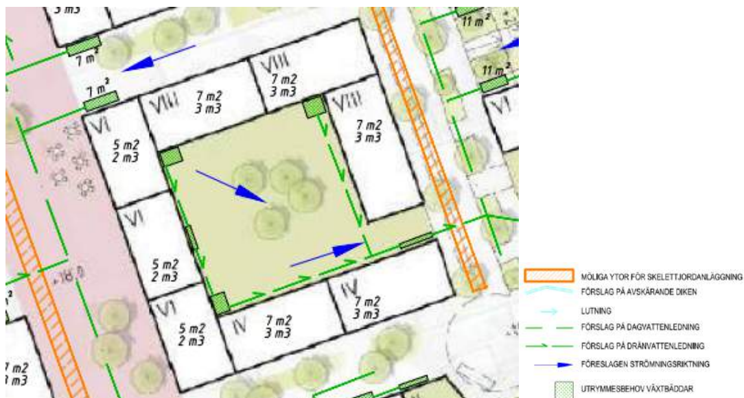
Figur 13: Exempel på placering av växtbäddar, dräneringsledningar och avrinningsvägar på delområde 7. Fastigheternas fördröjningskrav och växtbäddarnas utrymmesbehov redovisas på varje fastighet (för krav på mängd växtbäddar se Bilaga 1 och för föreslagen utformning se Bilaga 5)
