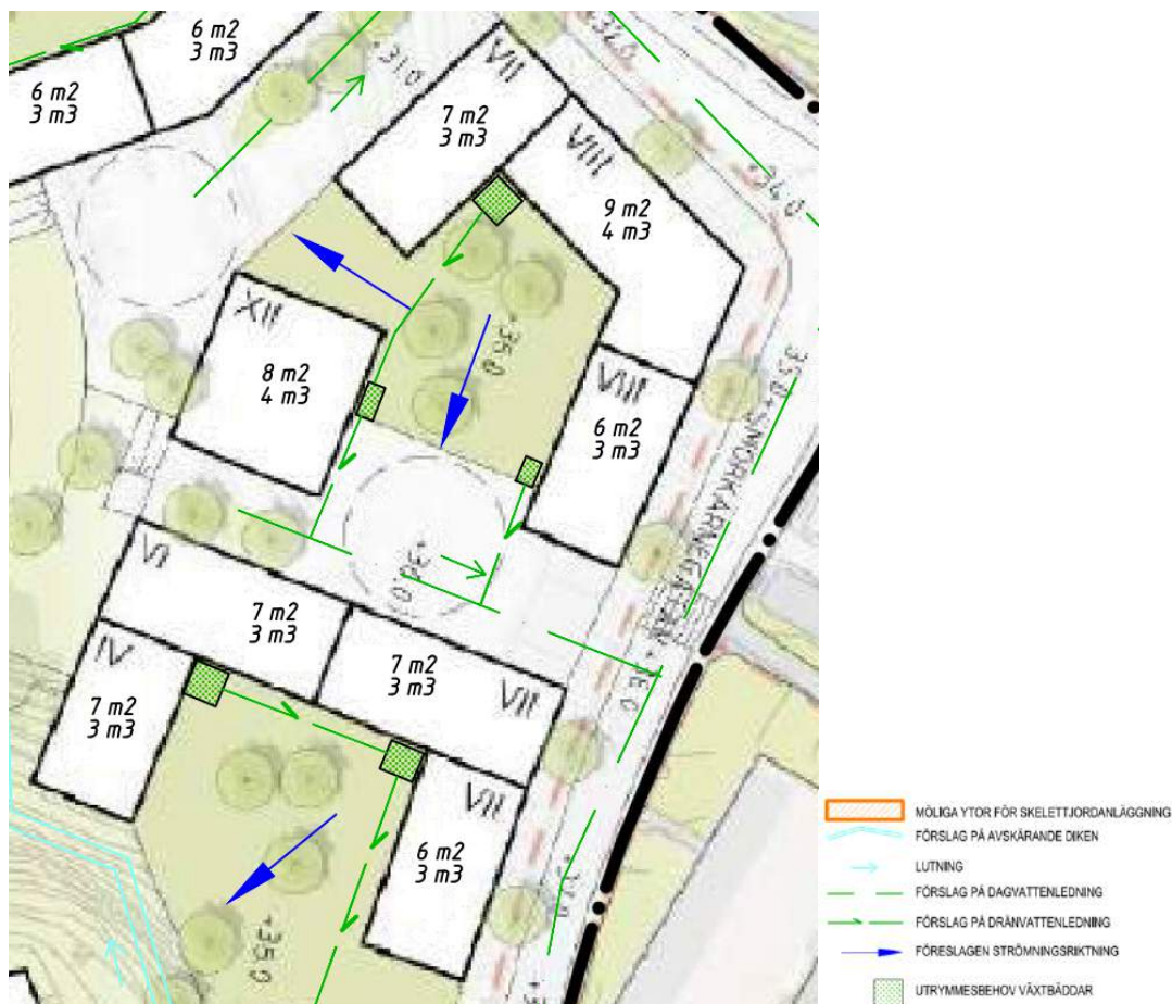
Figur 16: Exempel på placering av växtbäddar, dräneringsledningar och avrinningsvägar på delområde 11-12. Fastigheternas fördröjningskrav och växtbäddarnas utrymmesbehov redovisas på varje fastighet (för krav på mängd växtbäddar se Bilaga 1 och för föreslagen utformning se Bilaga 5)
