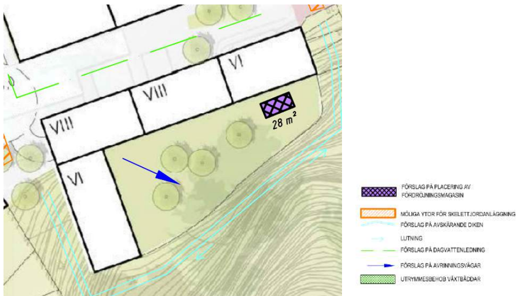
Figur 32: Exempel på placering av kassetter. För krav på dagvattenkassetter se Bilaga 1 och för föreslagen utformning se Bilaga 7.
