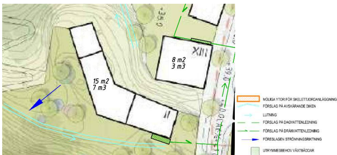
Figur 17: Exempel på placering av växtbäddar, dräneringsledningar och avrinningsvägar på delområde 13. Fastigheternas fördröjningskrav och växtbäddarnas utrymmesbehov redovisas på varje fastighet (för krav på mängd växtbäddar se Bilaga 1 och för föreslagen utformning se Bilaga 5)
