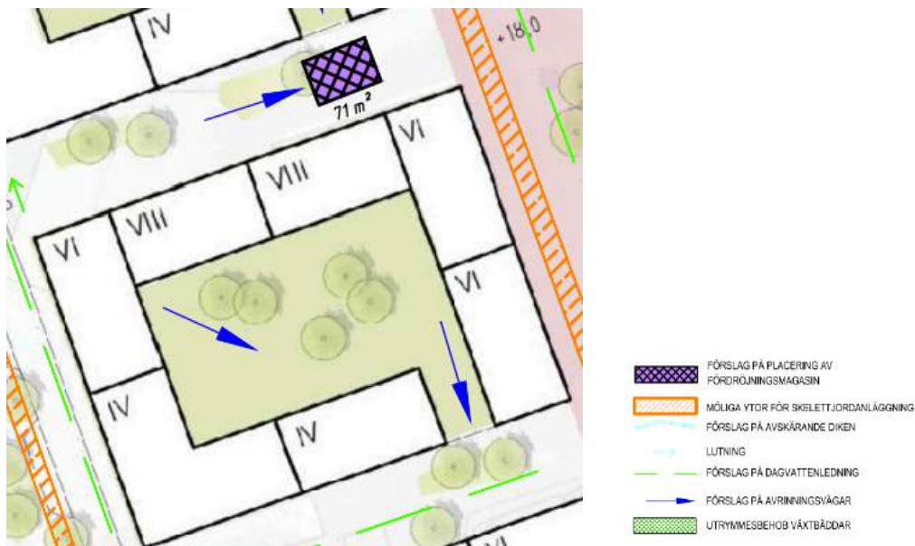
Figur 31: Exempel på placering av kassetter. För krav på dagvattenkassetter se Bilaga 1 och för föreslagen utformning se Bilaga 7.
